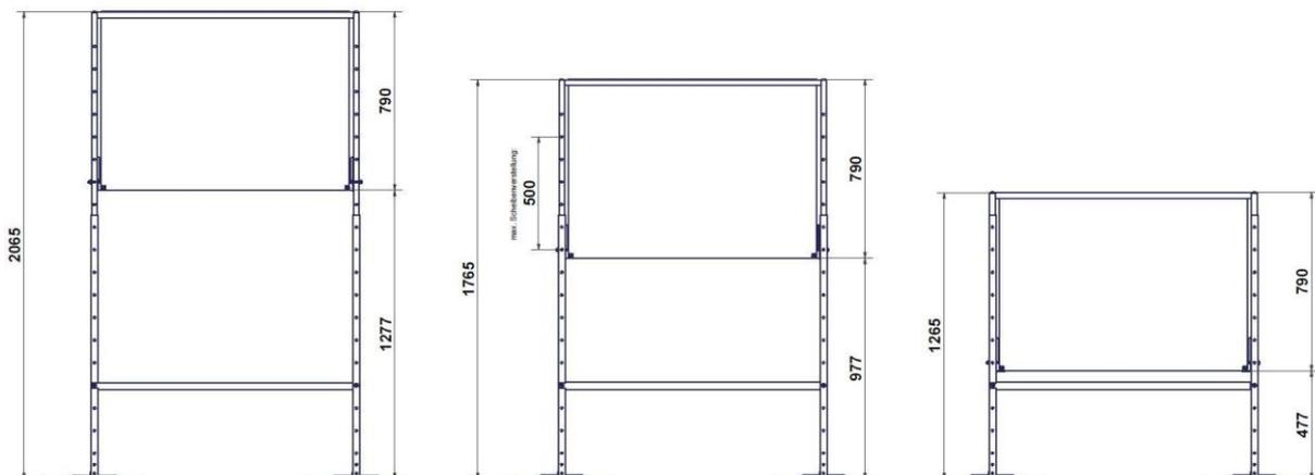
Zusätzlich kann die Scheibe höhenverstellt werden, wodurch eine maximale Höhe von 2568mm und eine minimale Höhe von 1265 erreicht werden kann.
